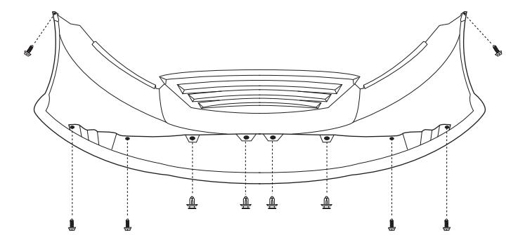
3. 図の A の箇所のピンをはずして、B の箇所の下側にあるフックをはずしながら スライドさせて純正グリルをはずしてください。
